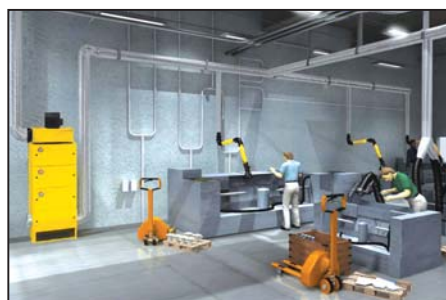
Impianto con bracci di aspirazione alla fonte e filtro MistEliminator
